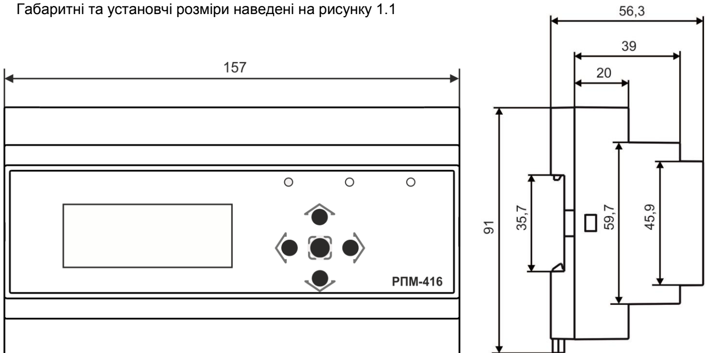
Рисунок 1.1 – Габаритні і установчі розміри реєстратора
