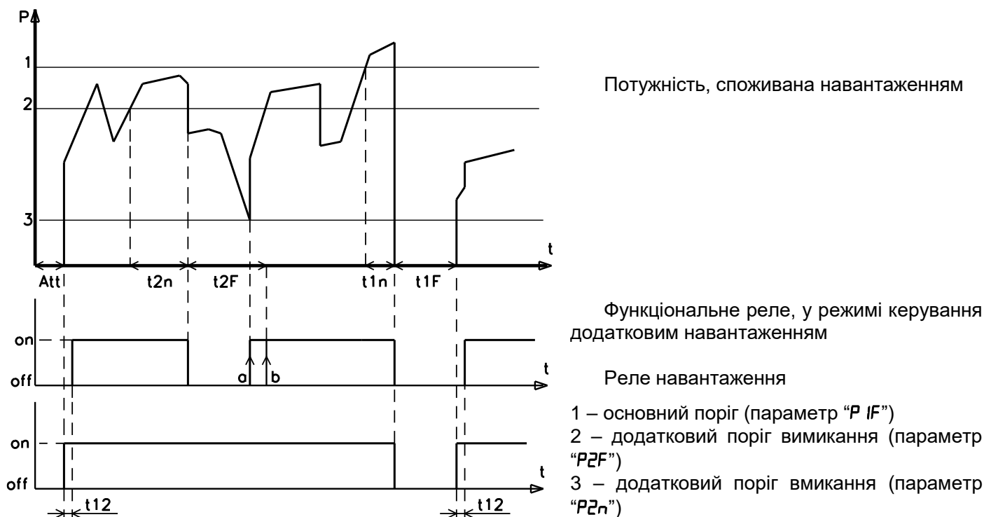
Рисунок 1.3 – Робота OM-310 у режимі обмеження потужності при rS=2
