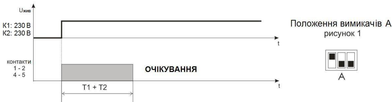
Рисунок 6 – Алгоритм роботи реле “Імпульсний 2”
