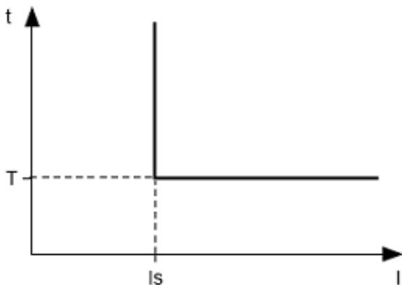
Рисунок 1.2 – Принцип захисту з незалежною витримкою часу
