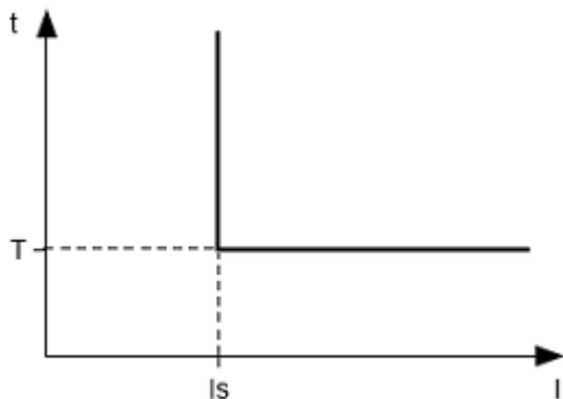
Рисунок 3.1 – Принцип захисту з незалежною витримкою часу
