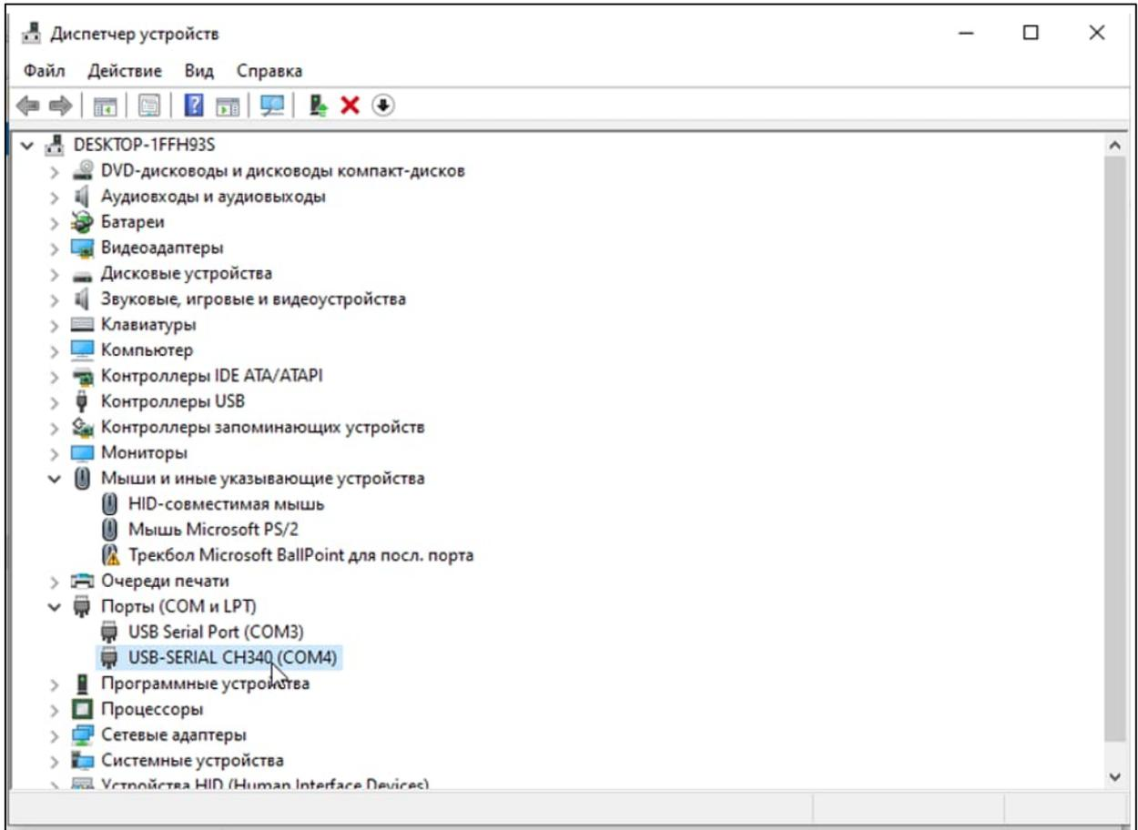
В Диспетчере устройств, в разделе "Порты (COM и LPT)" должен появиться новый виртуальный COM-порт "USB-SERIAL CH340".
