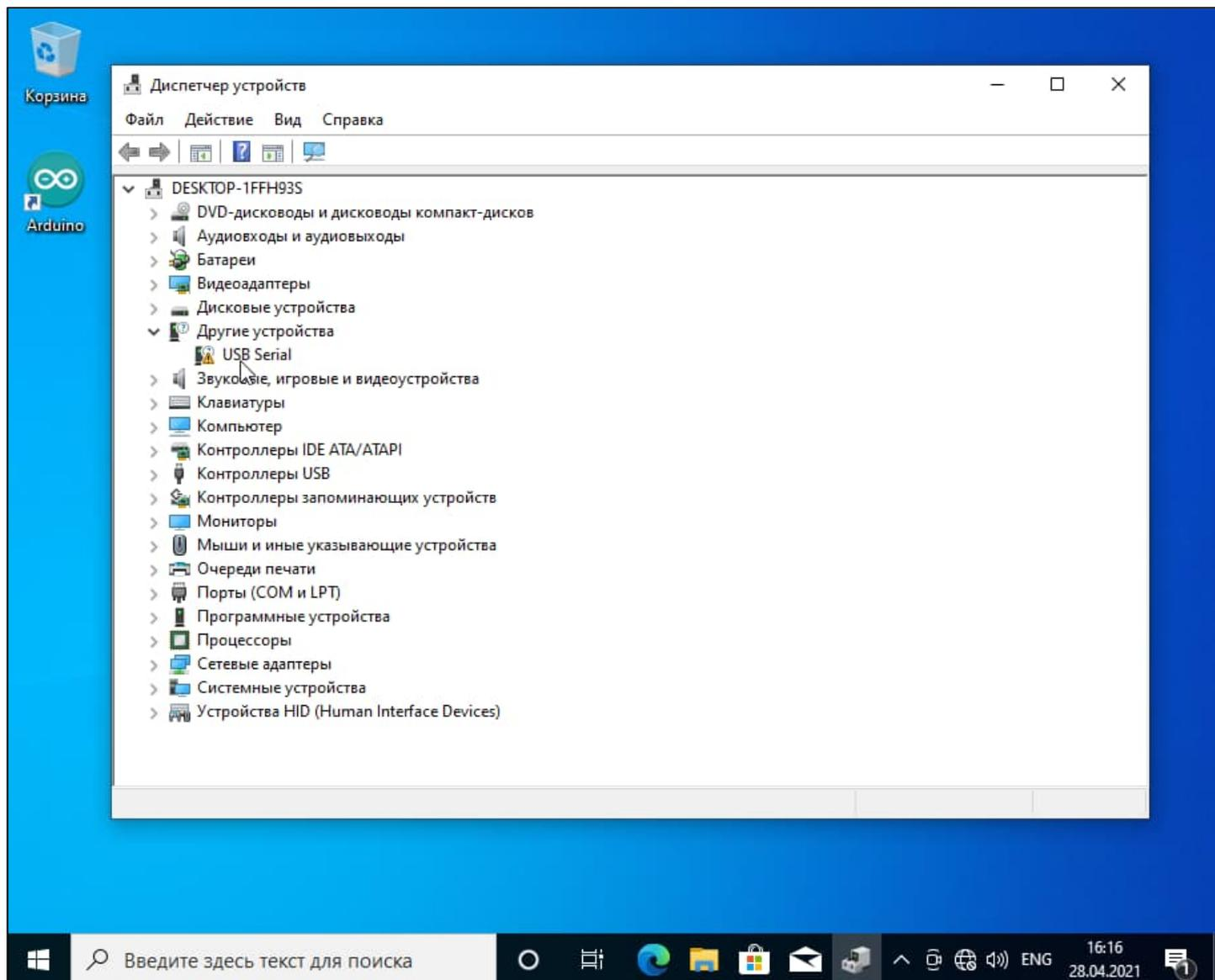
Откроется окно Диспетчера устройств, в нём должен быть пункт "**Другие устройства** - > **USB Serial**" с пиктограммой в виде жёлтого треугольника с восклицательным знаком.
